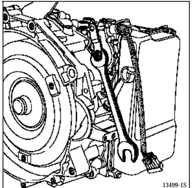
**IMPORTANT:** NEVER REMOVE THE POSITIONING PLATE LOCATED BEHIND THE MULTIFUNCTION SWITCH.
